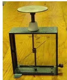
Observer puis interpréter les étapes de la série d'expériences suivante. On utilisera à de nombreuses reprises un schéma type de l'électroscope comme qui suit en positionnant correctement l'aiguille mobile :
